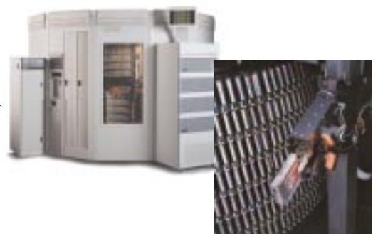
Рис. 1. Автоматизированная библиотека StorageTek Powderhorn и часть конструкции робота.
