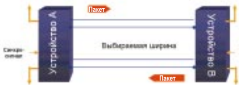
Рис. 6. PCI Express связь использует передающую и принимающую сигнал пары.
