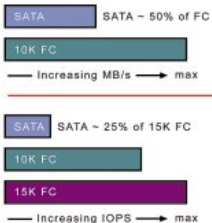
Рис. 9. Сравнение производительностей SATA- и FC-дисков на потоковых и случайных операциях ввода/вывода.
