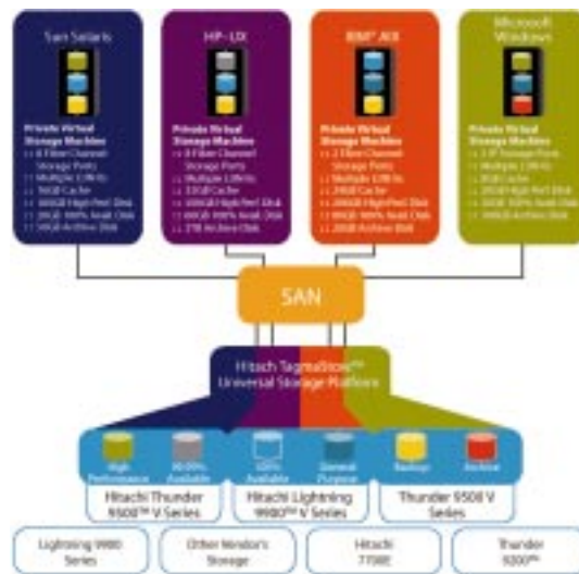
Рис. 3. Через разделение на партии можно создать до 32 Private Virtual Storage Machines из внутренней и подключаемых систем хранения, каждая с выделенной емкостью, кэшем и портами.
