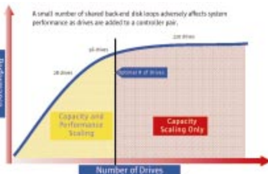
Рис. 1. Небольшое число разделяемых FC петель в модульных системах приводит к тому, что производительность не масштабируется с увеличением числа накопителей (пример для одной FC петли).
