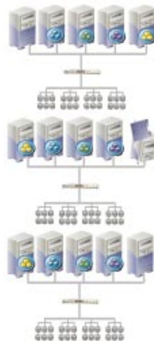
Рис. 2. Современный тип N+1 кластерной архитектуры – “плавающий” запасной сервер.
