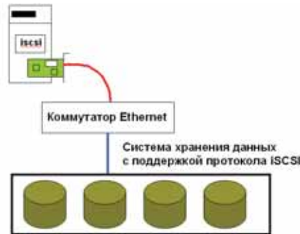
Рис. 6. Топология технологии iSCSI при использовании дискового массива с поддержкой iSCSI.
