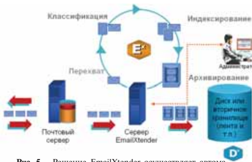
Рис. 5. Решение EmailXtender осуществляет автоматический перехват, классификацию, индексирование и архивирование сообщений.
