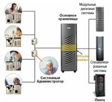
Рис. 3. DiskXtender обеспечивает поддержку самой разнообразной гетерогенной инфраструктуры для архивного хранения.
