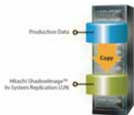
Рис. 3. В пределах системы хранения ПО ShadowImage In-System Replication создает и поддерживает полную копию LUN, которая занимает столько же места, как и оригинал.
