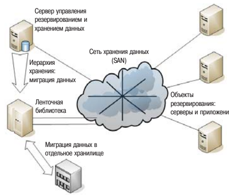
Рис. 5. Структурная схема реализованного проекта.
