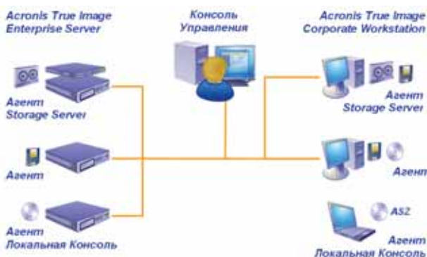
Рис. 1. Все операции резервного копирования в Acronis True Image осуществляются через устанавливаемые агенты, управление которыми можно поддерживать через центральную консоль управления.
