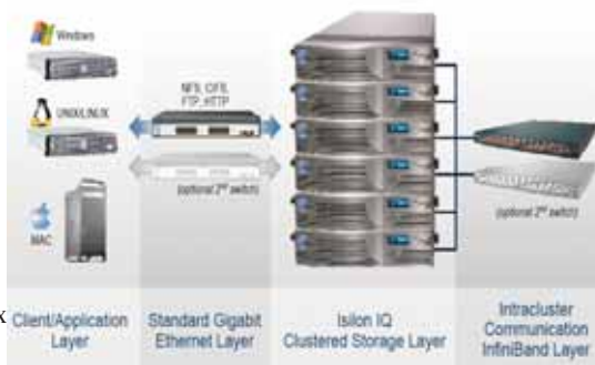
Рис. 2. Основные компоненты Isilon IQ кластера.
