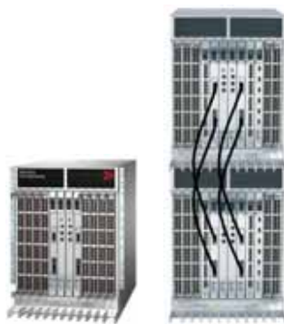
Рис. 7. DCX Backbone может конфигурироваться в систему из двух шасси, которая дает 896 8 Гбит/с FC-портов (768 универсальных = 384 x 2 плюс 128 ICL-портов).
