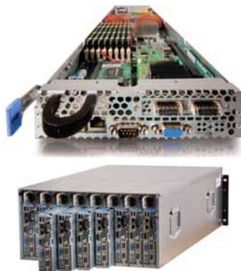
Рис. 4. Блэйд-сервер (вверху) и шасси с установленными 10 блэйд-серверами с передней стороны со снятым блоком вентиляторов (внизу), на базе которых построен суперкомпьютер “СКИФ-МГУ”.
