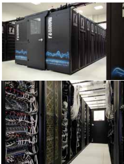
Рис. 3. Внешний вид системы СКИФ-МГУ: “снаружи” (вверху) и “изнутри” т.н. “горячий коридор” (внизу).
