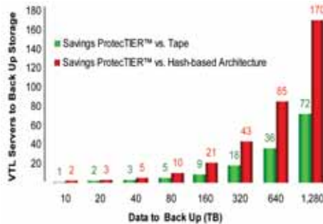
Рис. 5. Требуемое число VTL-серверов в зависимости от первичного объема бэкапирования (весна 2008 г.).
