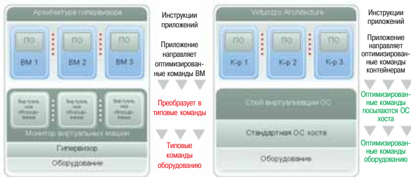
Рис. 2. За счет более высокого уровня эмуляции устройств и драйверов при гипервизорной виртуализации теряется оптимизация операционной системы.
