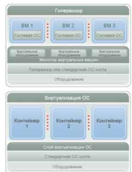
Рис. 1. Виды виртуализации для VDI-решений: аппаратная виртуализация (вверху) и ОС-виртуализация (внизу).
