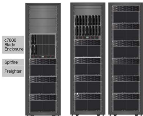
Рис. 4. Конструктивное исполнение в базовой (слева) и в максимальной конфигурации (справа) системы ExDS9100.
