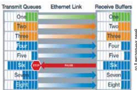
Рис. 4. Опция PFC дает возможность приоритетного управления потоками данных (без потерь пакетов и до 8 виртуальных линий на одном физическом линке).
