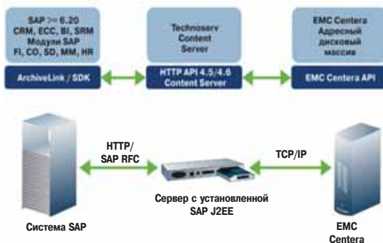
Рис. 5. Общая архитектура решения по архивированию данных модулей SAP с помощью решения Technoserv Content Server.
