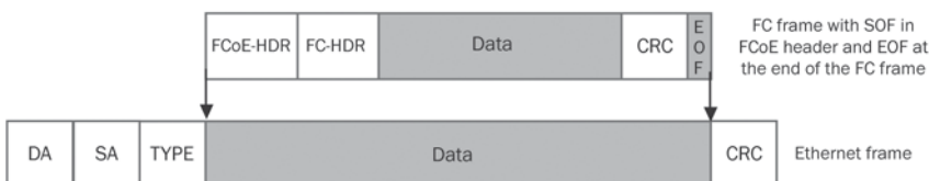
Рис. 5. Ethernet-фрейм с инкапсулированным FC-фреймом.
