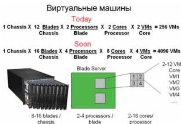
Рис. 9. Среднее число виртуальных машин на одном блэйд-шасси сегодня и в ближайшей перспективе.
