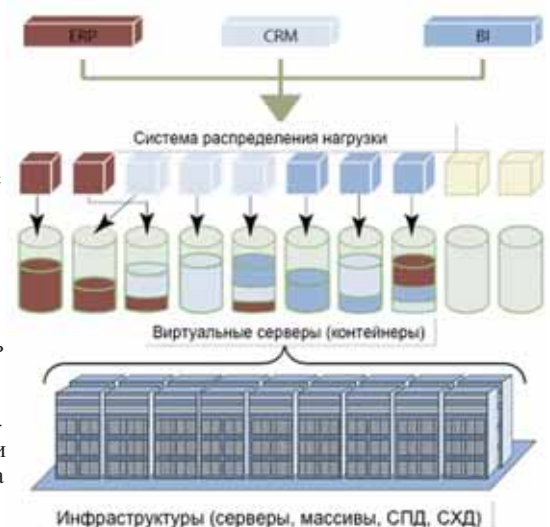
Рис. 1. Основные характеристики cloud computing включают в себя: стандартизованную инфраструктуру с оболочкой виртуализации, а также динамическую систему контроля и распределения нагрузки на систему.
