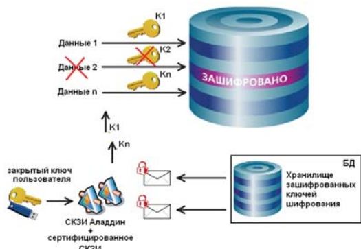
Рис. 3. Для каждого пользователя прикладной системы создается ключевая пара (открытый и закрытый ключи) при помощи ПО выбранного криптопровайдера.
