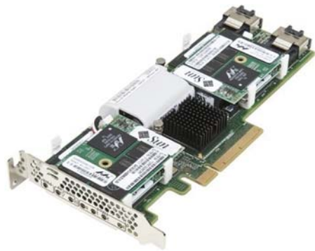
Рис. 4. Конструктивное исполнение Sun Flash Accelerator F20 PCIe Card.
