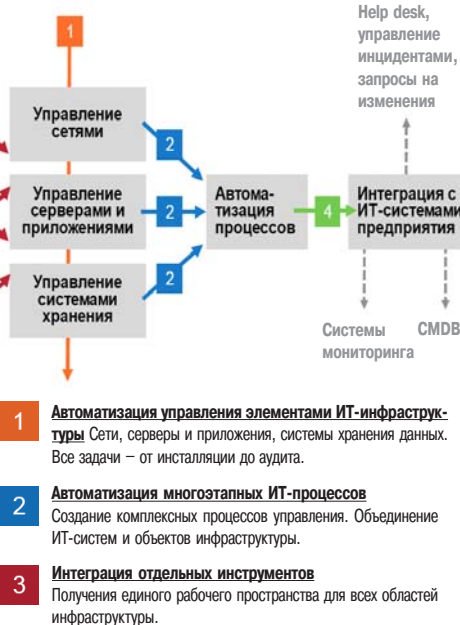
Рис. 10. Интеграция компонент и процессов на основе продуктов HP Datacenter Automation.
