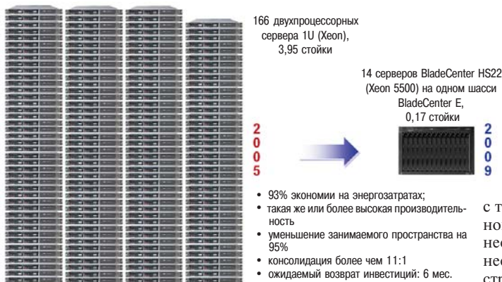
Рис. 8. Результат замены 166 рэк-серверов IBM 2005 г. на 14 блэйд-серверов выпуска 2009 г.
