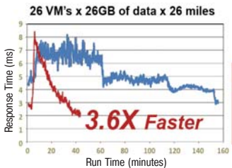
Рис. 3. При миграции 26 ВМ между двумя площадками (39,6 км) время перемещения ВМ составило 9 мин., а время переноса данных и приложений сократилось 3,6 раза.
