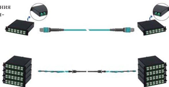
Рис. 6. Варианты использования претерминированных кабельных систем в зоне MDA.
