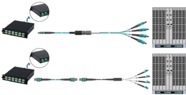
Рис. 7. Варианты использования претерминированных кабельных систем в зоне EDA.
