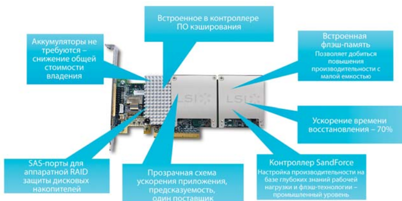
Рис. 1. LSI Nytro MegaRAID не только поддерживает кэширование данных на базе технологии твердотельных накопителей (SSD), но обеспечивает легкое и безопасное использование этой технологии.
