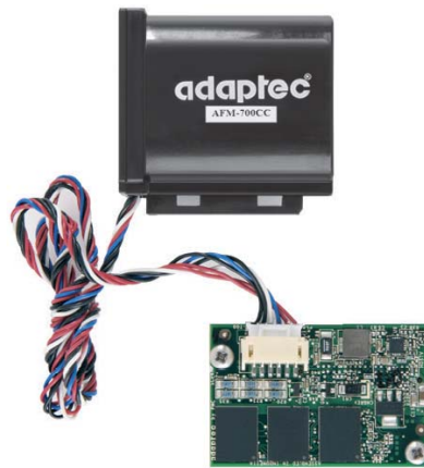
Рис. 3. Adaptec Flash Module (AFM) состоит из двух основных компонентов: суперконденсатора и флэш-памяти.
