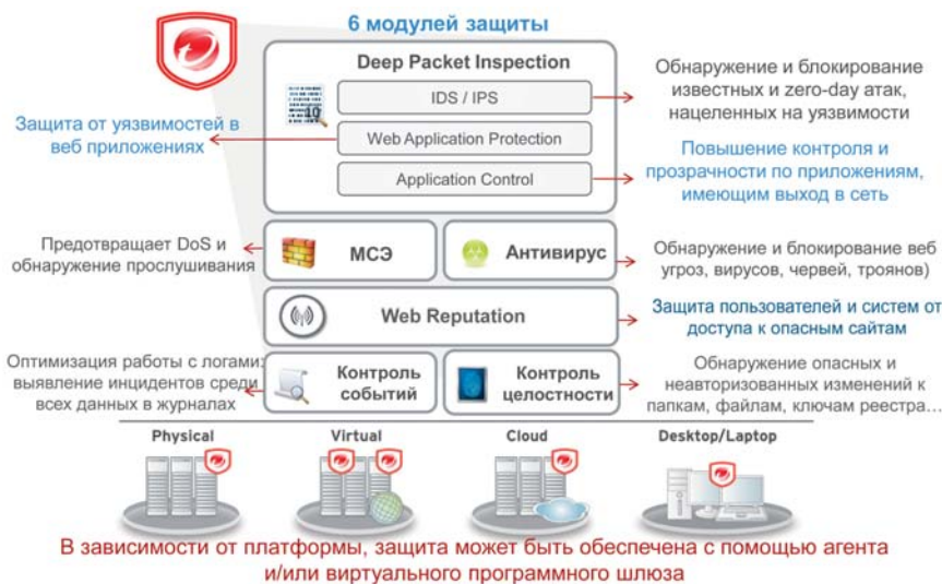
Рис. 2. Архитектура Deep Security строится по модульному принципу.
