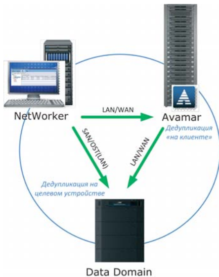
Рис. 5. Пример интеграции основных продуктов EMC BRS – Avamar, Data Domain и Networker – между собой.
