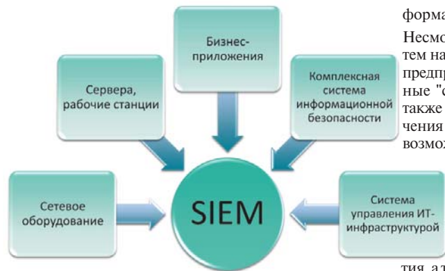
Рис. 2. Архитектура потоков данных в SIEM-решениях.
