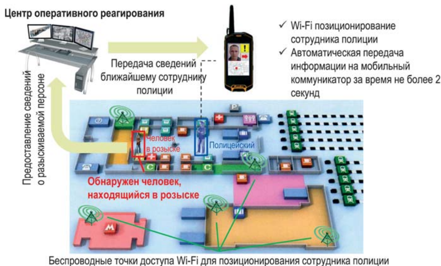
Рис. 1. Система "Каскад-Поток" позволяет не только выполнить идентификацию на отдельно взятых рубежах контроля, но и осуществить сопровождение объекта (биометрический трекинг), а также оперативно информировать сотрудников полиции о его местоположении.
