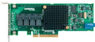
Рис. 1. SAS HBA Adaptec 71605Ne с поддержкой до 128 дисков и возможностью шифрования (нет функции RAID).
