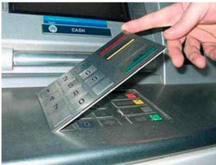
Рис. 2. Пример накладной клавиатуры для банкомата, которая используется злоумышленниками для получения доступа к PIN.
