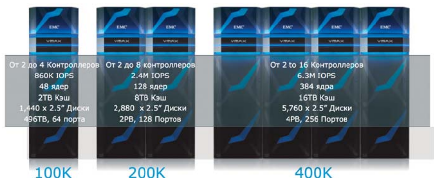
Рис. 1. Базовые аппаратные характеристики VMAX 3.
