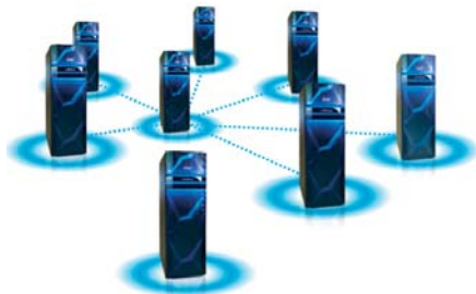
Рис. 4. Возможность разнесения стоек VMAX на расстояние до 25 метров от system bay 1.
