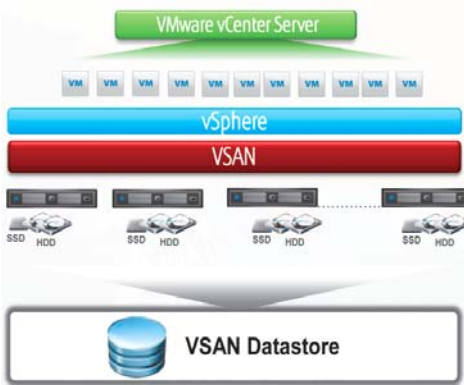
Рис. 3. vSAN обеспечивает гибкую простую масштабируемую инфраструктуру с SSD-кэшированием.
